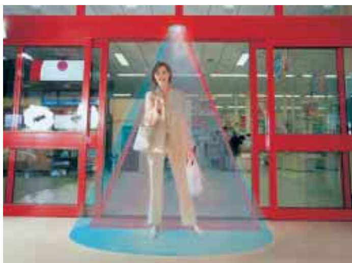
Il sensore a doppia tecnologia ACTIV8 contiene il radar di movimento unidirezionale per il comando d'apertura e una doppia tenda a infrarossi attivi per la sicurezza delle porte scorrevoli.
