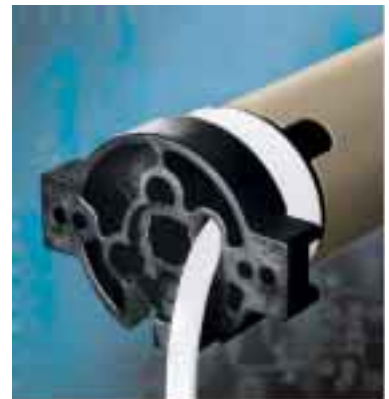
POLDO Motoriduttore serie 50 con finecorsa elettronico ad autoapprendimento che permette la regolazione in modo automatico dei punti di fine corsa sfruttando la prima chiusura e apertura completa della tapparella sul quale è montato. POLDO è dotato di un sistema di sicurezza che gli permette di arrestarsi in caso di ostacoli incontrati durante la fase discendente della tapparella.
