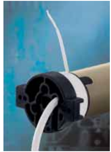
SAT IS/SAT IS SOFT 50 Motoriduttore con fine corsa elettronico comprensivo di un sistema radio ricevente comandato da un telecomando capace di regolarne anche i fine corsa. Nella versione SOFT permette la riduzione di coppia; è quindi ideale per le tende da sole cassonate.
